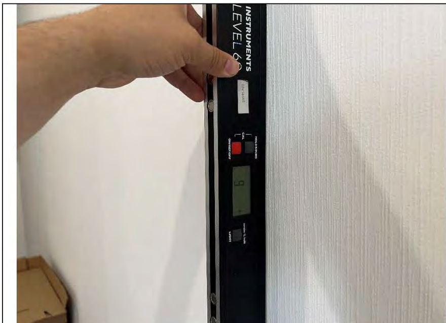
Фото №16. Измерение уровня стен в прихожей.
