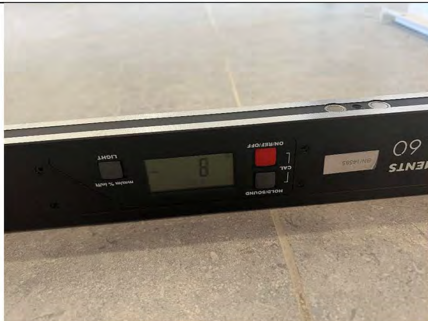
Фото №32. Измерение уровня напольного покрытия в прихожей.
