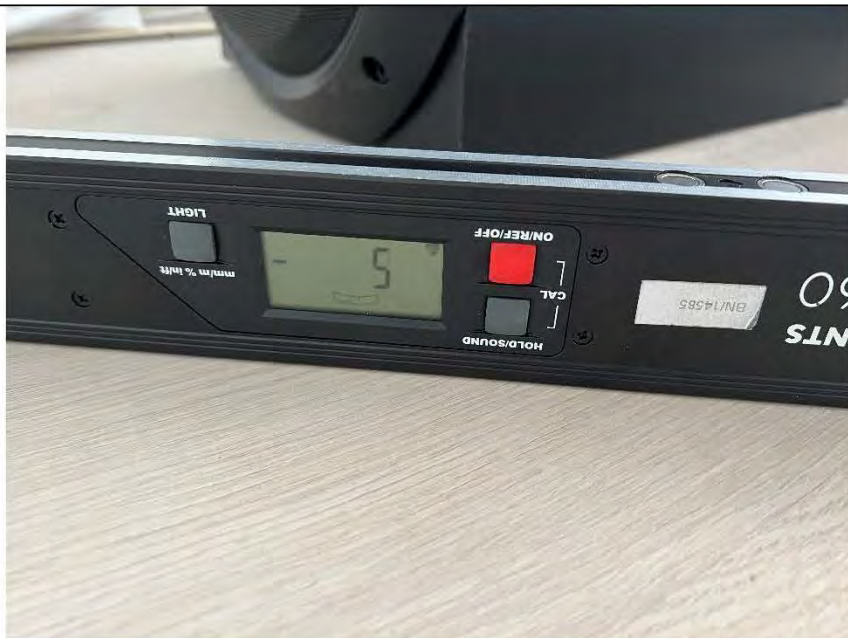
Фото №28. Измерение уровня напольного покрытия в кухне.
